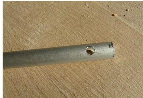
Für den oberen Teil des Gestells braucht man 2 Rohrstangenstücke, und ein kleines Reststück von der Gewindestange. Durch beide Rohrstangenstücke muss man genau in der Mitte (bei 15cm) ein Loch bohren (durchmesser 3mm). Bei einer Rohrstange muss man dieses Loch abschrägen mit der Bohrmaschine. Dann legt man die zwei Röhren über kreuzt aufeinander, steckt das Gewindestück dazwischen und befestigt es mit 2 Gewinden.
